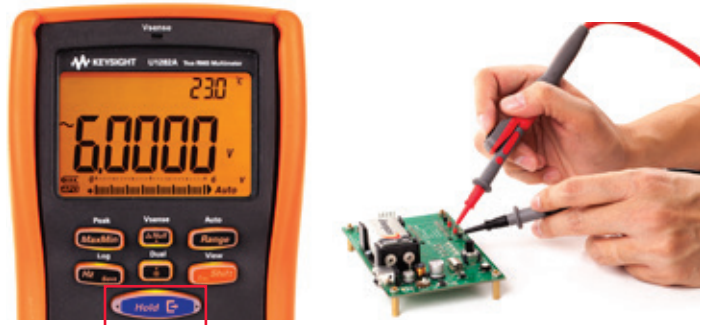
Figura 5. O botão 'Hold & Export' realiza três funções em um único clique: mede, salva na memória do DMM de mão e exporta a medição através da porta de infravermelho. A ponta de prova com ativação remota U5404A opcional emula o botão 'Hold & Export'.
