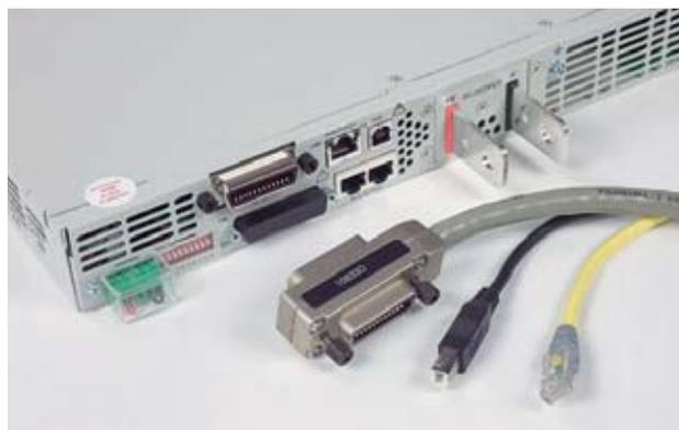
Figura 2. As interfaces Ethernet, USB 2.0 e GPIB integradas facilitam as conexões do sistema.
