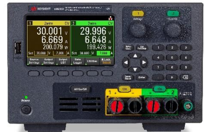
E36233A 400W Fonte de alimentação com escala automática e saída dupla 30V, 20A
