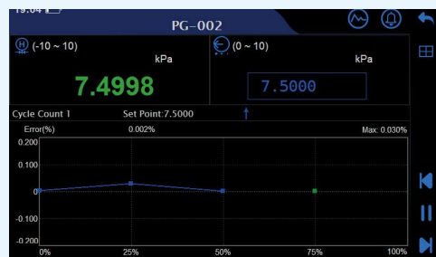
Pressão manométrica / transmissor / teste de contato
